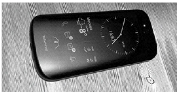
*Рисунок 3 – "YotaPhone", E-ink дисплей, первый в мире мобильный телефон (смартфон) с двумя сенсорными экранами. Обратная сторона с экраном на электронных чернилах. 2014, Россия. Пример успешного дизайна, выполненного в стиле "актуальной эстетической целесообразности"
